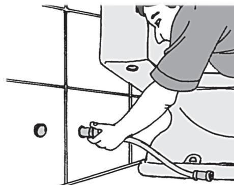
17. Prueba la instalación haciendo que el tanque se llene de agua hasta la marca que viene grabada en la parte interna del tanque.
