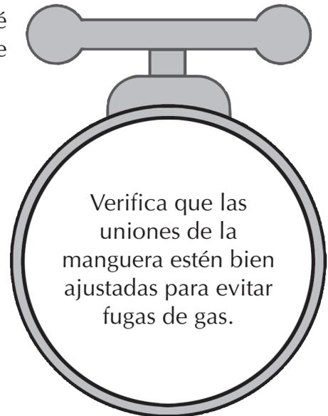
11. Después de unos minutos abre la salida de agua caliente de un aparato sanitario conectado al calentador y obtendrás agua caliente. Así puedes asegurar que se ha realizado una buena instalación.
