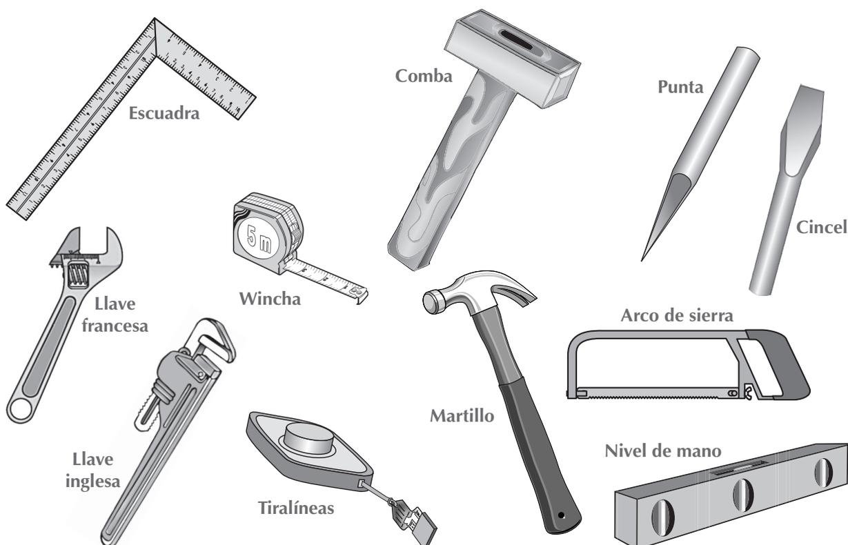
Las herramientas se pueden clasificar según su uso. Así tenemos: herramientas de verificación o medición, trazado, corte, ajuste y de percusión.
