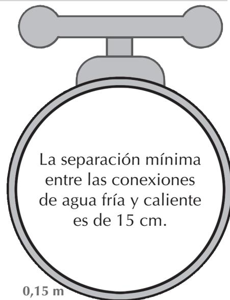
La separación mínima entre las conexiones de agua fría y caliente es de 15 cm.
