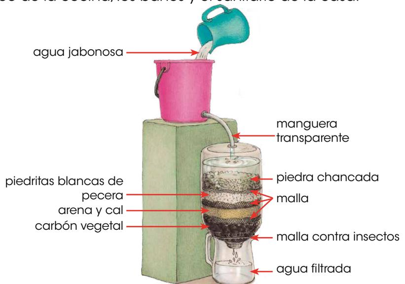
Los resultados demostraron que el filtro puede elaborarse con materiales 100 % reciclables, de bajo costo y fácil acceso, por lo que su uso es posible en cualquier hogar. El filtro tiene la capacidad de retener las impurezas producto del lavado por fuerzas sencillas de infiltración y capilaridad. Esta agua filtrada no es potable, pero sirve para otros usos domésticos.
